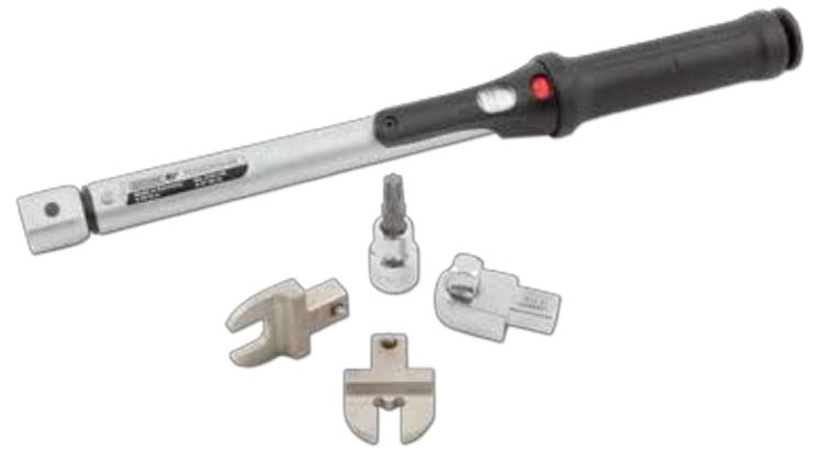
マルチマスターご利用の際の注意点として、過度の締付はねじ部の破損を引き起こす可能性があります。一方、締付が十分ではない場合、ビビリが発生し、工具寿命の低下や加工精度への影響があります。そこで、ねじの締付には、トルクスビット交換式レンチを使用することで適切なトルクで締付を行うことが可能です。
