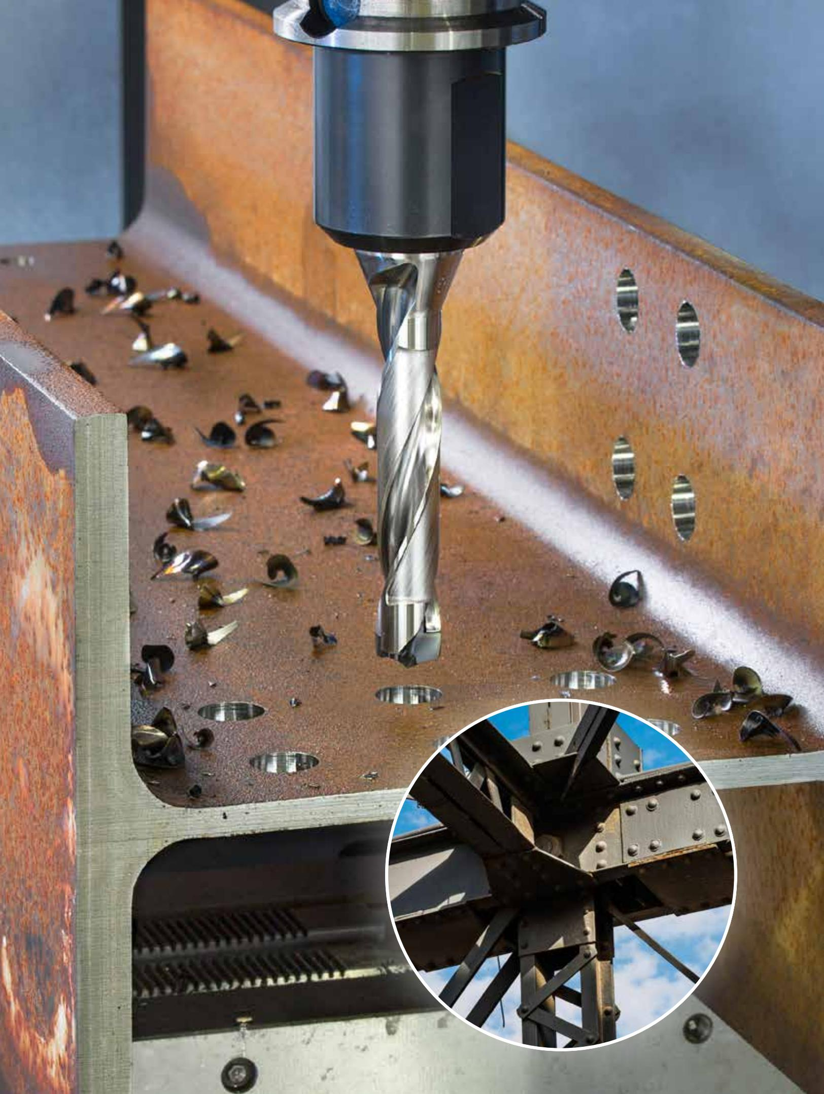
イスカルのカムIQドリルとスモウカムIQは、ビームとフレームの穴あけ加工において優れた性能を発揮します。湾曲した独創的な切刃形状により、セルフセンタリング機能を搭載し、下穴加工が不要となります。また高精度仕上げが可能のため、バリ取りが不要となります。多くの場合、ビームの穴あけ加工時にはクーラントの供給が問題となり、ドライ加工もしくはそれに準ずる加工が推奨されます。カムIQドリル・スモウカムIQは、MQLでの最小のクーラント供給での加工にも適しています。
