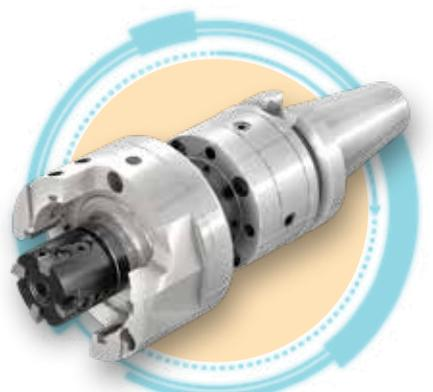
Kombinationswerkzeug zum Außenreiben mit einstellbarer PKD-Schneide, Führungsleisten und auswechselbarem Fräskopf mit PKD-gelöteten Kassetten
